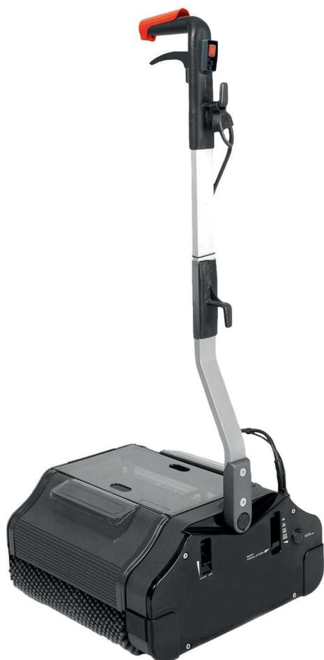
Le Duplex 420 Steam vapeur convient à la fois comme nettoyeur pour sols et comme nettoyeur vapeur. Le gros avantage de cette machine de nettoyage de Duplex est qu'elle peut également être utilisée avec de la vapeur, grâce au générateur de vapeur. Avec le Duplex 420 vapeur, la saleté la plus tenace n'a aucune chance et le nettoyage des sols est soudainement très facile. Ce nettoyeur vapeur Duplex peut être utilisé sur tous types de sols. C'est ce qui rend le Duplex 420 vapeur si polyvalent.
