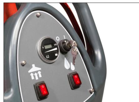
La largeur de travail de 55 centimètres gagne en popularité. Cette TGB6055 combine cela avec un grand réservoir d'eau de 60 litres. Ce modèle est également disponible en version tractée (T). Une performance pratique de 1400 m<sup>2</sup> est réalisable avec cette machine. Les batteries (2x 12V 100Ahr) fournissent suffisamment d'énergie pour fonctionner pendant plus de deux heures. La machine a un chargeur intégré.
